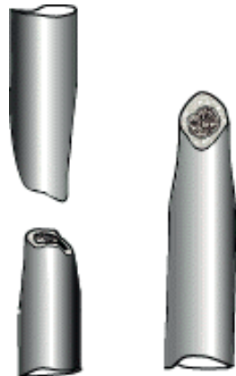
Рис. 8. Пример разрушения пластичных материалов при растяжении
