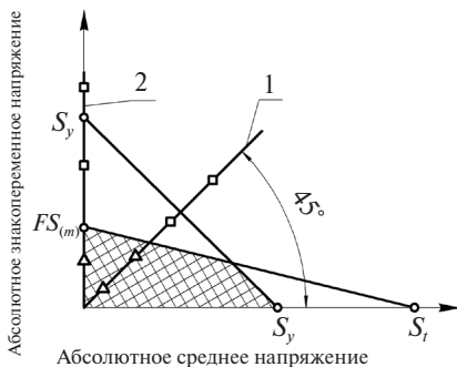
Рис. 60. Диаграмма проверки усталости:
